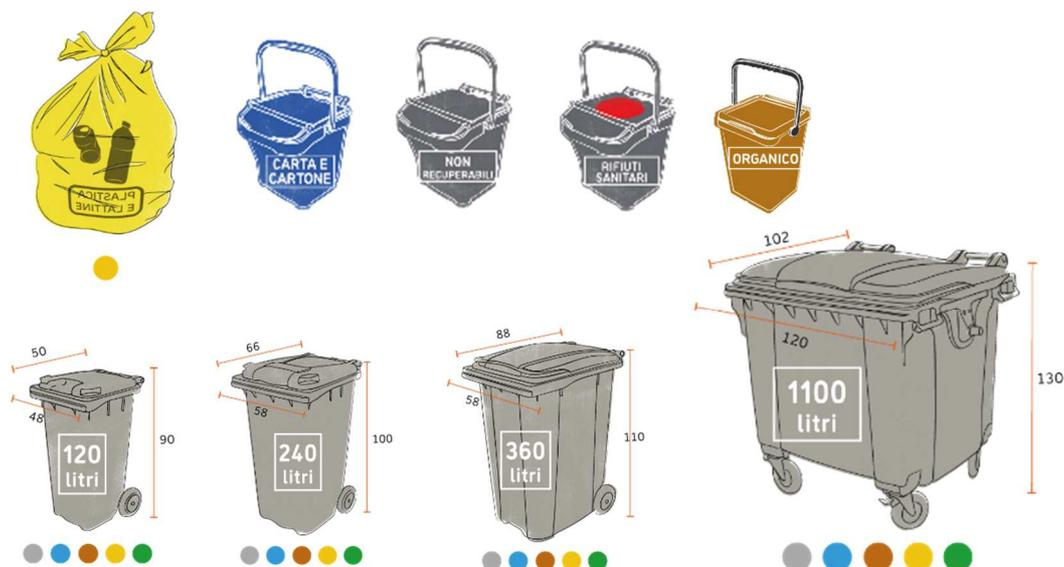
Figura 1: esempio di volumetria e dimensione (cm) dei contenitori adibiti alla raccolta dei rifiuti con modalità "porta a porta".
